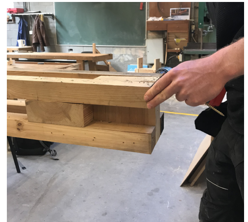
Détails du remplacement du croisillon en multi-plex par un croisillon en bois-plein
