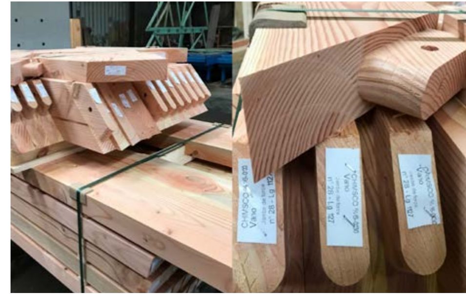
Figure 95 : Eléments de poutre à connexion tenons et mortaises. (Source : Caroline Morizur, efp)
