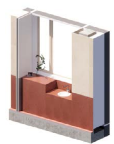
Figure 154 : Un élément modulaire intégrant un lavabo. (Source : archipelago architects)
