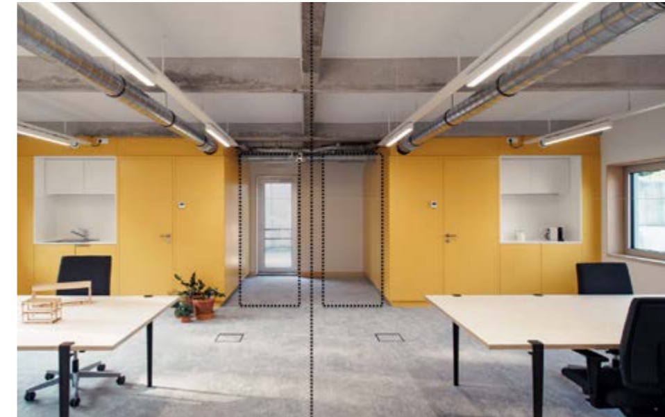
Figure 101 : Illustration de division future de l'espace bureau du CRL en deux logements (Source : Architectural Engineering, VUB)
