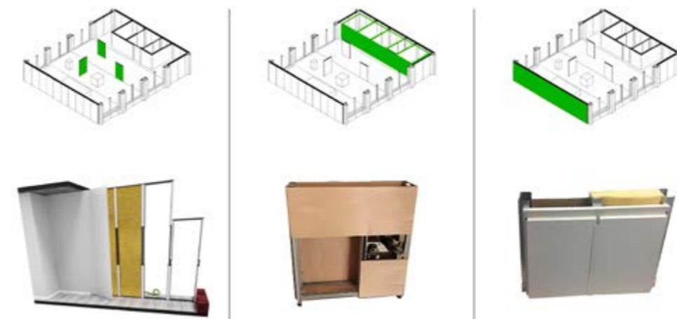
Figure 102 : De gauche à droite : un système à connexion velcro (Source : Architectural Engineering, VUB ; Juunoo), un système kit-of-parts (Source : Geberit) et un système à profilé (Source : Architectural Engineering, VUB ; Saint-Gobain)
