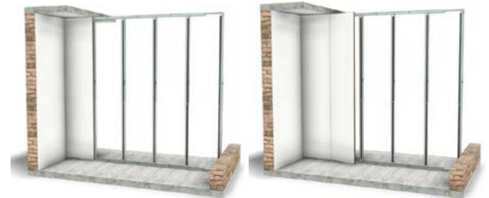
Figure 170 : Système de parois intérieures modulaire et démontable. Les panneaux sont fixés avec du Velcro et s'emboîtent les uns dans les autres. (Source: JUUNOO)
